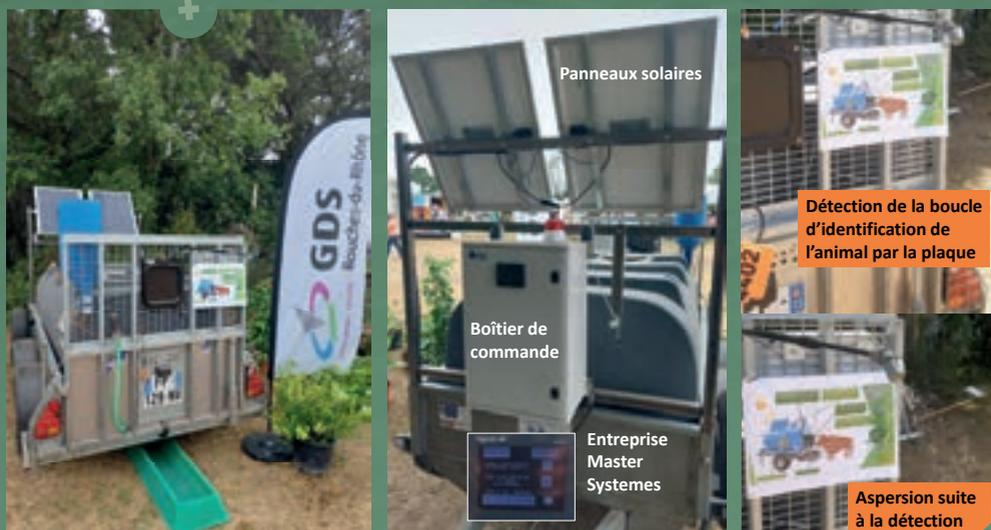
Prototype de distributeur basé sur un système d'abreuvement (citerne d'eau, abreuvoir).
