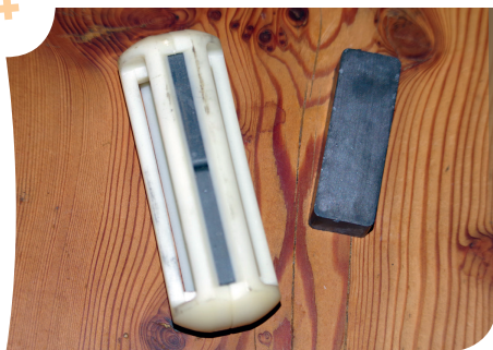
Aimant cage à gauche, aimant nu à droite
