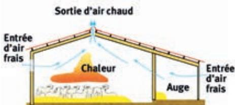
*“Les entrées d'air sont situées sur les longs pans à plus de 2m du sol, avec 3 systèmes principaux: filet brise-vent, bardage ajouré, tôle perforée ou à ventelles. La sortie d'air a lieu au faîtage sur toute la longueur du bâtiment (prévoir une ouverture de 15 à 25 cm avec une faîtière pare-vent placée en retrait) et au niveau des ouvertures latérales.”*
